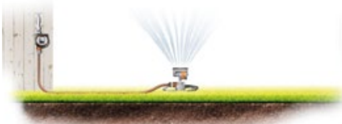
Irrigazione fuori terra
