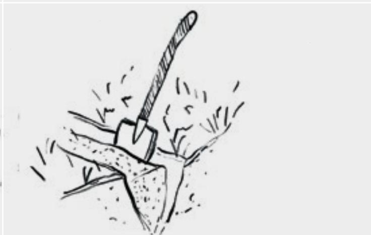
**F** Creuse avec une bêche une tranchée en forme de V de 20-25 cm de profondeur. Enlève avec précaution la surface recouverte de pelouse puis dégage la terre. Enlève les pierres tranchantes. **Astuce : il est conseillé de tondre et d'arroser au préalable la pelouse pour faciliter cette première partie des travaux.**
