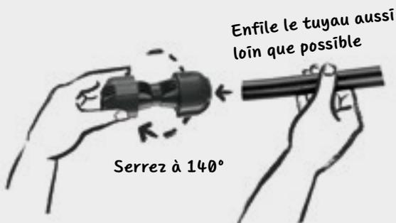
**C** Raccorde les différents composants. Glisse les tuyaux sur env. 6 cm à l'intérieur du raccord par le joint torique. Le raccordement est alors étanche. Le joint torique est positionné après environ 4 cm. Arrivé au niveau de ce joint, pousse encore le tuyau jusqu'à la limite.
